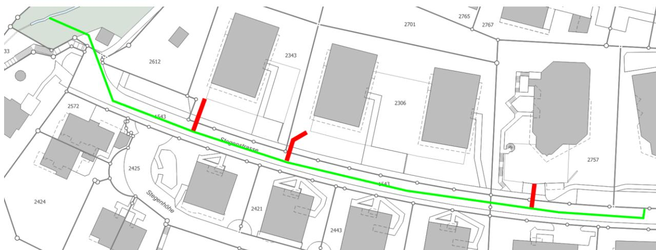
Abbildung 3: Neue Liegenschaftsanschlüsse (rot markiert) an Trennsystem (grün markiert) anschliessen
